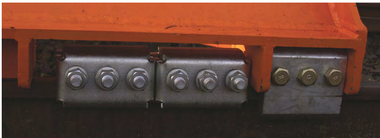
Фрикционные башмаки и узел предотвращения наползания.
